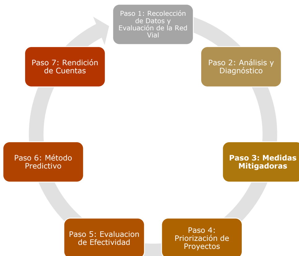
Figura 76. Proceso de Administración de la Seguridad Vial
