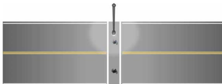
Figura 45: Diseño Peligroso de la Iluminación de un Cruce Peadonal
